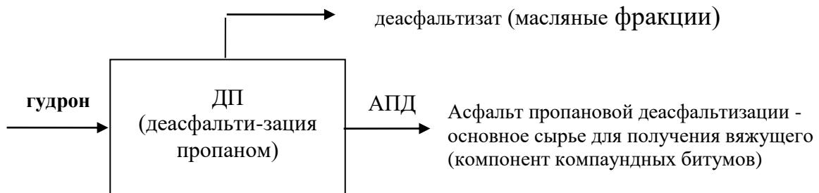
Б. Углубленная деасфальтизация пропанобутановой фракцией
