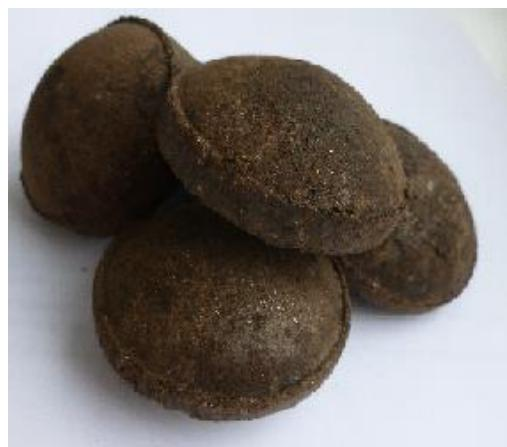
Рисунок 3.4 – Полусферические образцы для испытания на одноосное сжатие
