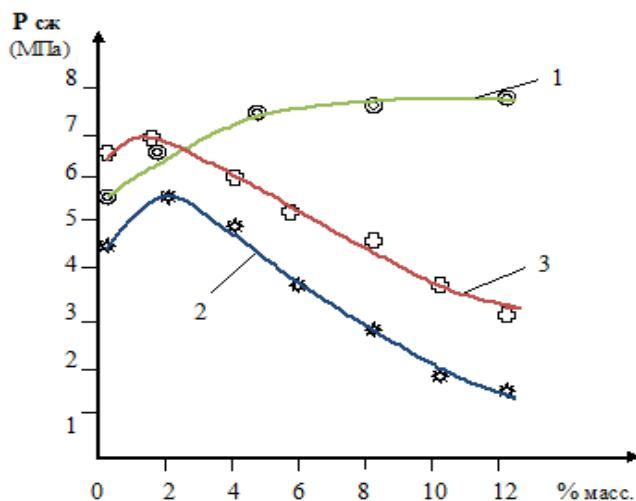
Рисунок 3.2 – Зависимость прочности при одноосном сжатии брикетированных образцов пылей с различными связующими в зависимости от их расхода в % масс:
