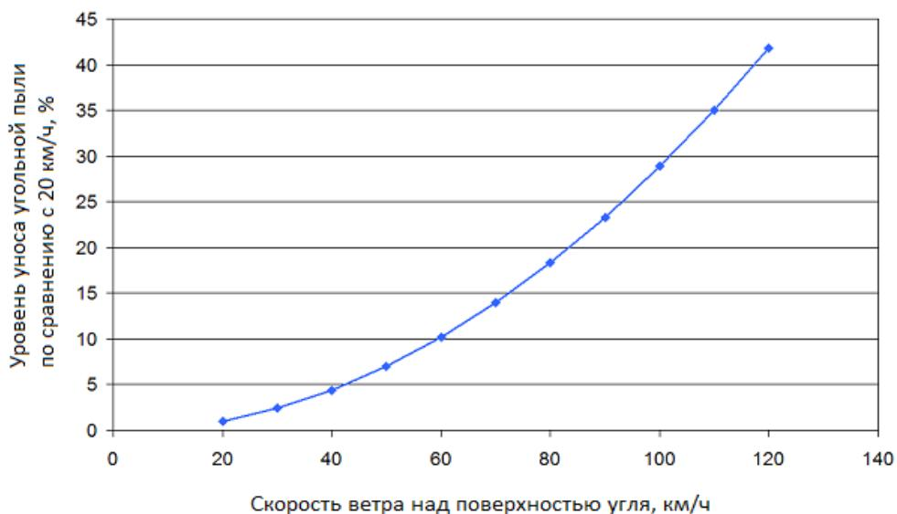
Рисунок 3.9 – Удельный сдув угольной пыли в зависимости от скорости ветра над его поверхностью
