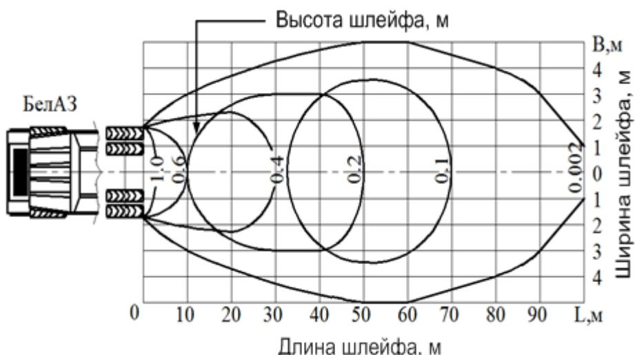
Рисунок 1.1 – Пылевой аэрозоль от автомобиля внутри пылевого шлейфа по проф. П. Л. Олькову [27]
