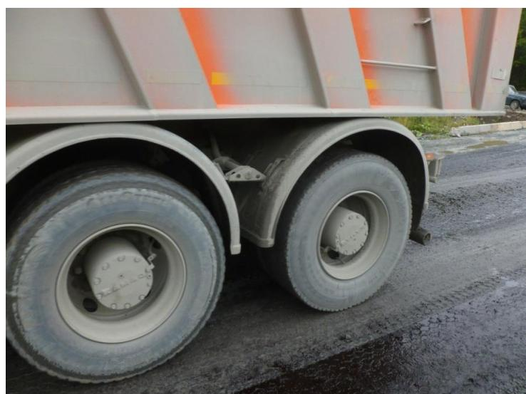
Рисунок 4.9 – Установленный факт отсутствия загрязнения шинной резины автотранспорта от профилактической эмульсии и эмульсионно-минеральной смеси, нанесенной на поверхность карьерной дороги
