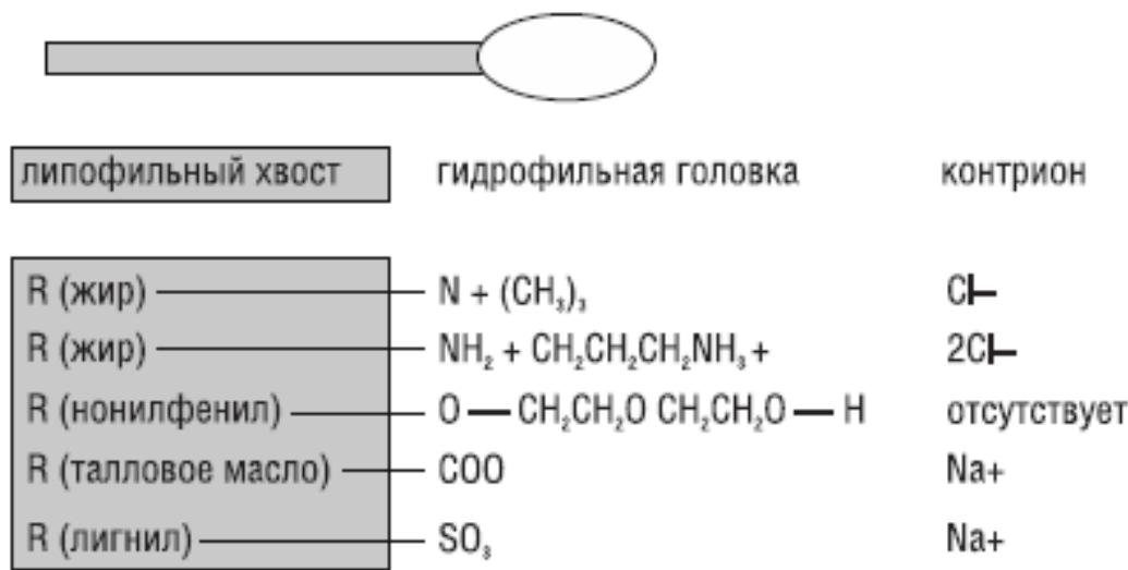
Рисунок 1.10 – Типичные поверхностно-активные вещества (ПАВ) в роли эмульгаторов битумных эмульсий
