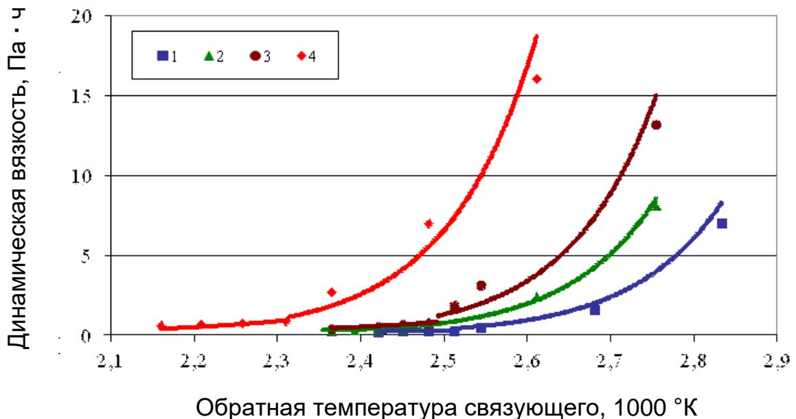
Рисунок 2.9 – Вязкостно-температурная характеристика органических вяжущих: 1 – АПД 38; 2 – АПД 43; 3 – компаунд; 4 – битум БН 70/30
