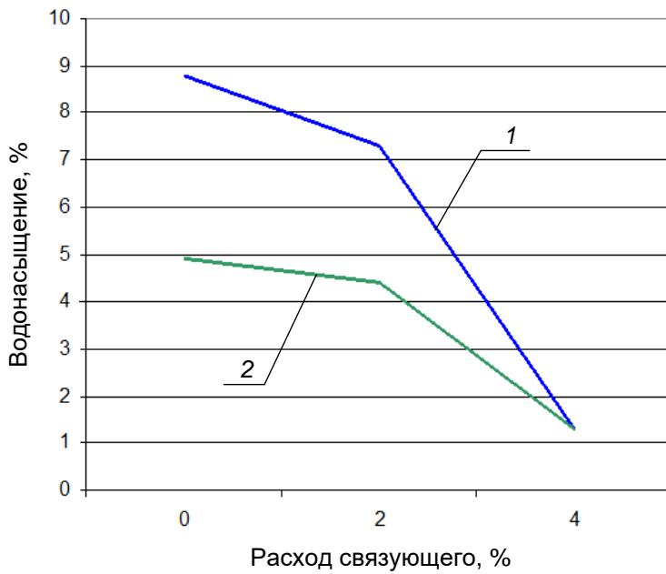
Рисунок 3.3 – Зависимость расхода эмульсионного связующего от водонасыщения золы уноса для дорожных эмульсий ЭБК-2 и эмульсий АПД:
