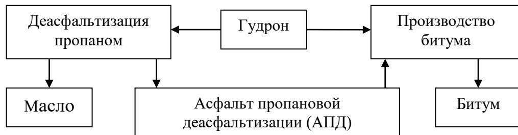
Рисунок 3.11 – Принципиальная схема производства битума из ТГО
