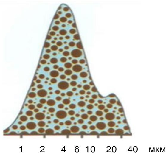
Рисунок 1.8 – Распределение частиц битумной эмульсии по размерам
