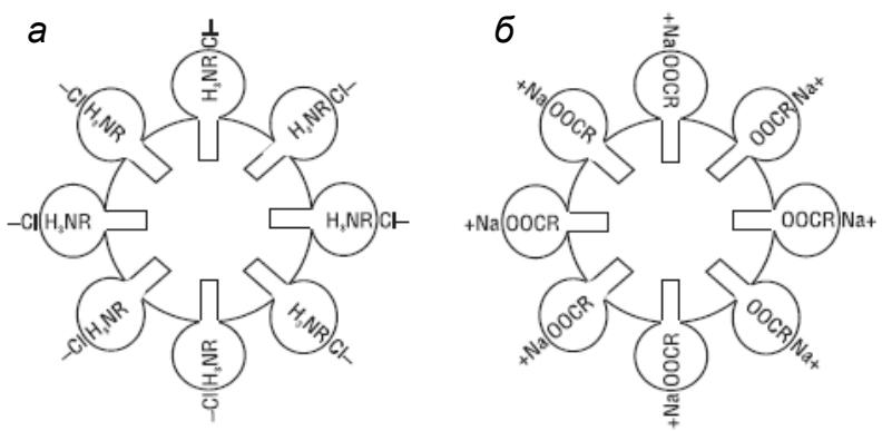
Рисунок 1.9 – Схемы глобул дисперсной фазы с оболочками из адсорбированных ионов водорастворимого эмульгатора:
