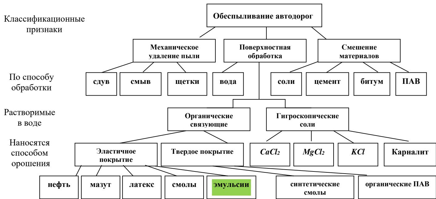
Рисунок 1.7 – Существующие технологии обеспыливания карьерных автодорог по способу обработки и применяемым реагентам
