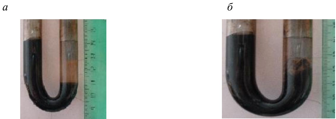
Рисунок 2.14 – Рабочий орган установки для определения электрокинетического потенциала эмульсии методом электрофореза:
