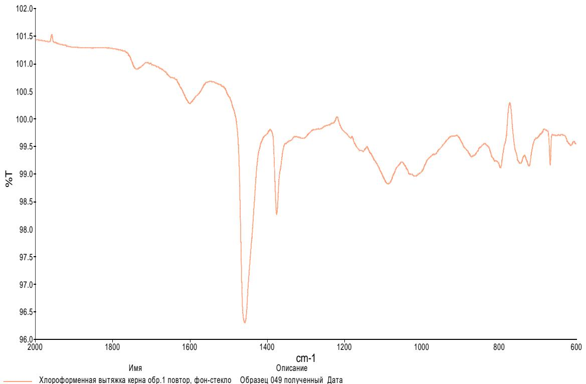
Рисунок. 3.6 – ИК-спектр ХБА образца брикета, измельченного до частиц размером 3х3 мм (проба I')
