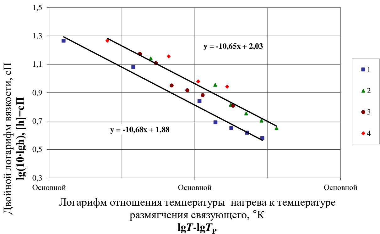
Рисунок 2.8 – Логарифмическая вязкостно-температурная характеристика органических вяжущих:
