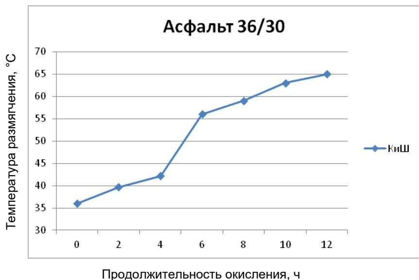
Рисунок 2.6 – Зависимость температуры размягчения ( $T_p$  КиШ, °C) от продолжительности окисления (ч) для Асфальта 36/30 (ПНОС)
