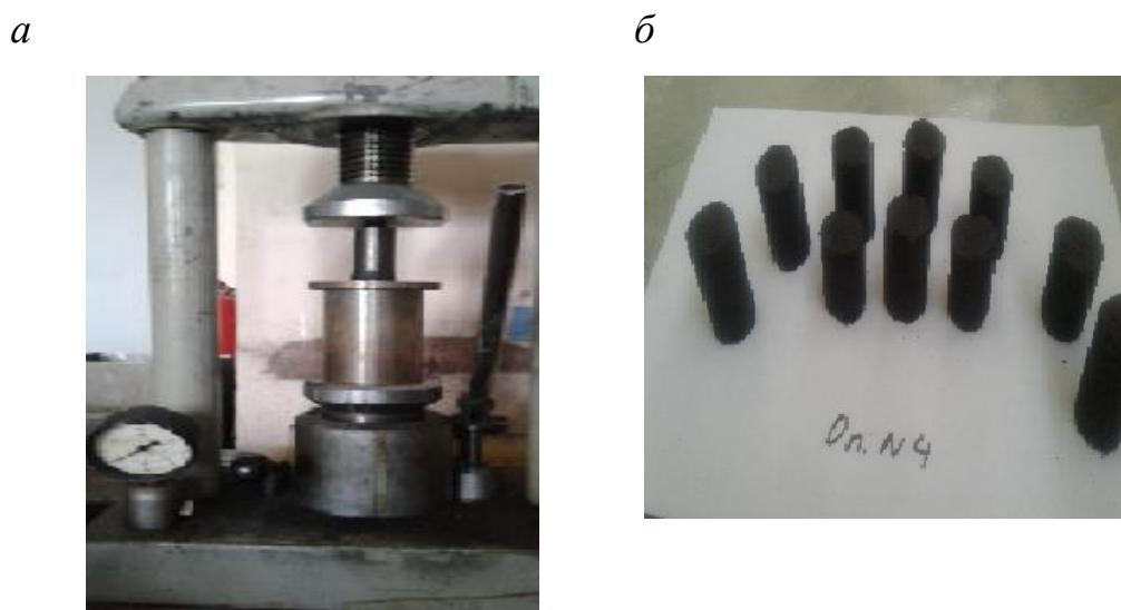
Рисунок 3.1 – Формовочный пресс ОЗ ВУХИН, УДНИИ (а),
