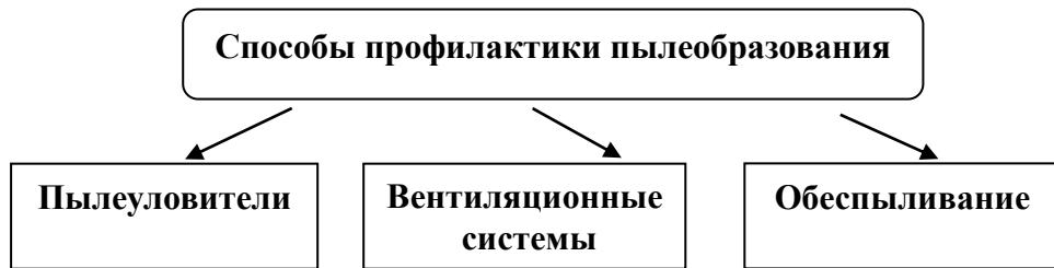
Рисунок 1.3 – Классификация применяемых в технологии способов пылеподавления
