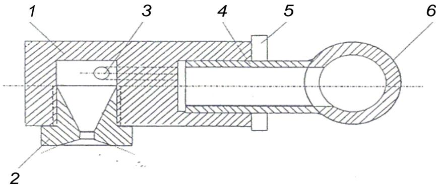
Рисунок 4.6 – Конструкция аэрозольной форсунки для профилактической эмульсии:
